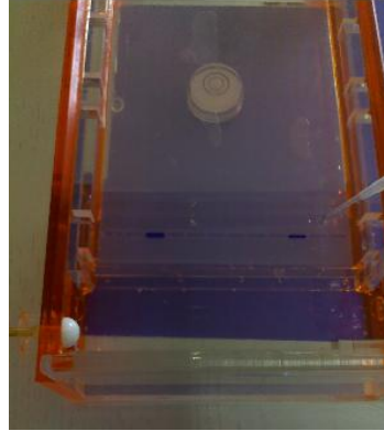
Figure 8: injection of 10µl of sample into the wells of gel / الصورة 8: وضع 10 ميكروليتر من العينة في فتحة الهلام
