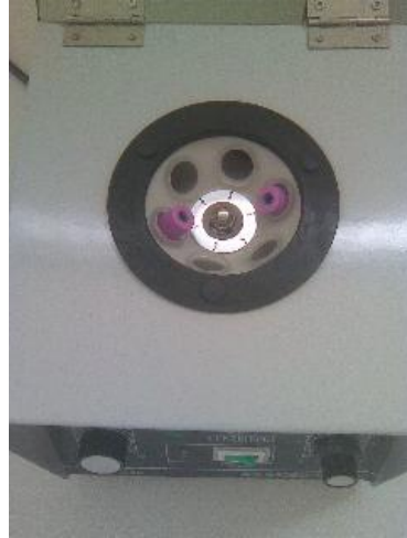
Figure 2: centrifugation at 4000rpm for 8min / الصورة 2: عملية الفصل على 4000 آر.بي.أم لمدة 8دقائق
