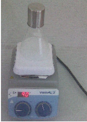
Figure 6: Dissolve the gel at 90°C with agitation / الصورة 6: تذويب الهلام على 90°م مع التحريك.
