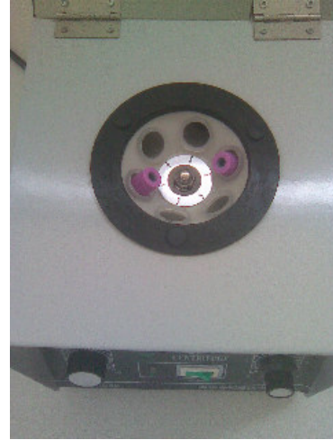
Figure 2: centrifugation at 4000rpm for 8min / الصورة 2: عملية الفصل على 4000 آر.بي.آم لمدة 8دقائق
