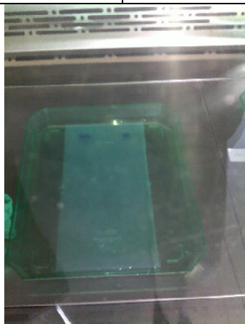
Figure 11: soaking the gel with ethidium bromide for 30min. الصورة 11: نقع الهلام ببرميد الإيثيديوم لمدة 30 دقيقة
