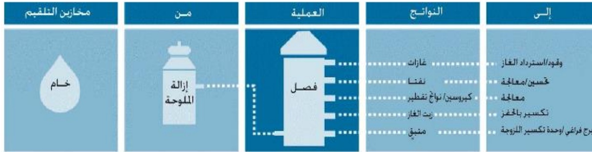
الشكل 5.78. عملية التقطير الفراغي
