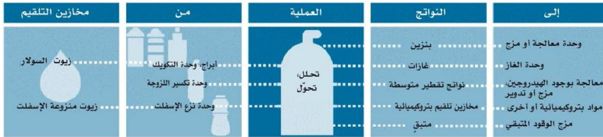
الشكل 10.78 . مخطط عملية التكسير بالحفز
