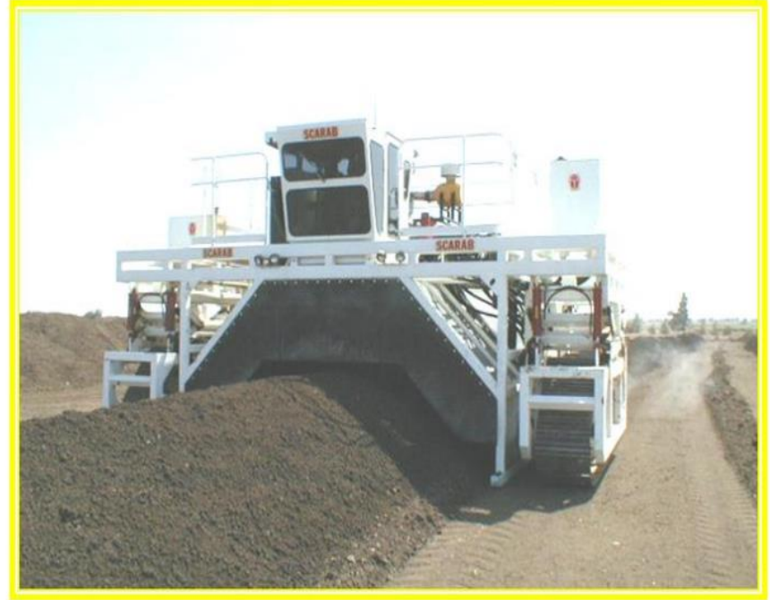
صور رقم ٨ توضح شكل مصفوفة الحمأة وعمليات التقليل الميكانيكي
