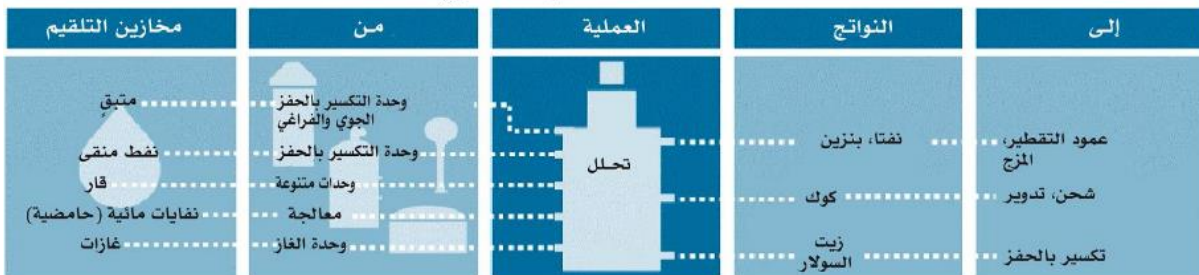
الشكل 9.78 . عملية التكسير بالحفز
