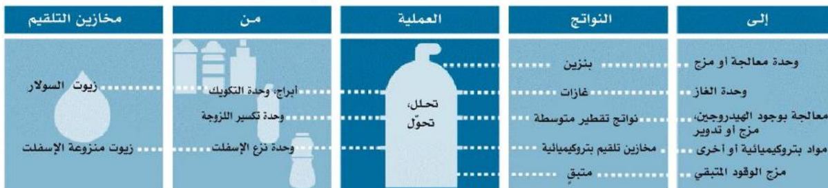
الشكل 10.78 . مخطط عملية التكسير بالحفز
