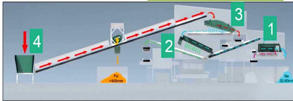
Bild 7: Konfiguration einer Rostaschenaufbereitungsanlage
