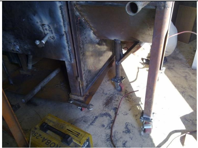
Verdampferzug und Überhitzerzug auf Rollen gebracht
