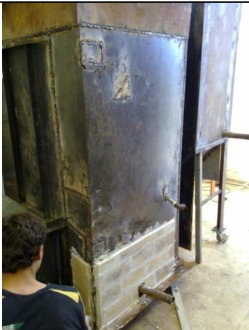
Luftdichte Rohranbindung am Verdampferzug oben
