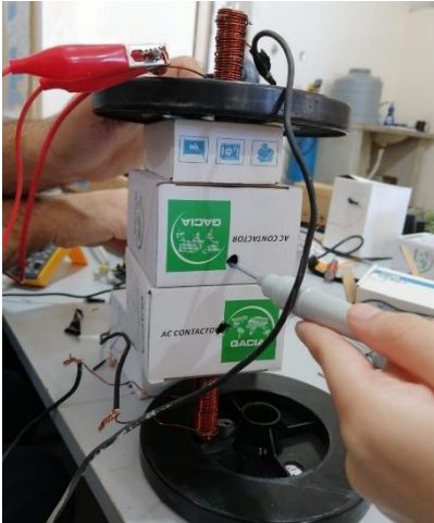
Figure III. 51: Évaluation du champ magnétique lors du positionnement de deux solénoïdes en face l'un de l'autre
