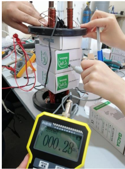
Figure III. 51: Évaluation du champ magnétique lors du positionnement de deux solénoïdes en face l'un de l'autre
