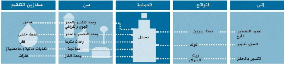
الشكل 9.78 . عملية التكويد بالتحفز
