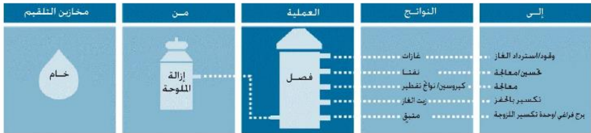
الشكل 4.78 .مخطط عملية التقطير الجوي
