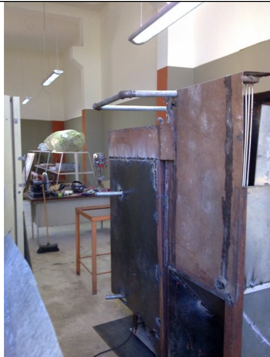
im Bild vorne: Überhitzerzug, hinten: Verdampferzug
