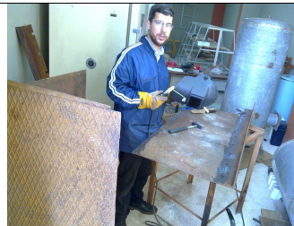
Polieren (Rost entfernen) vor dem Schweißen und Schweißen
