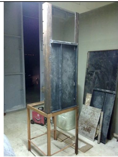
Bild oben rechts: geschweisste Hinterseite des Brennkammerzugs (Zug 1)
