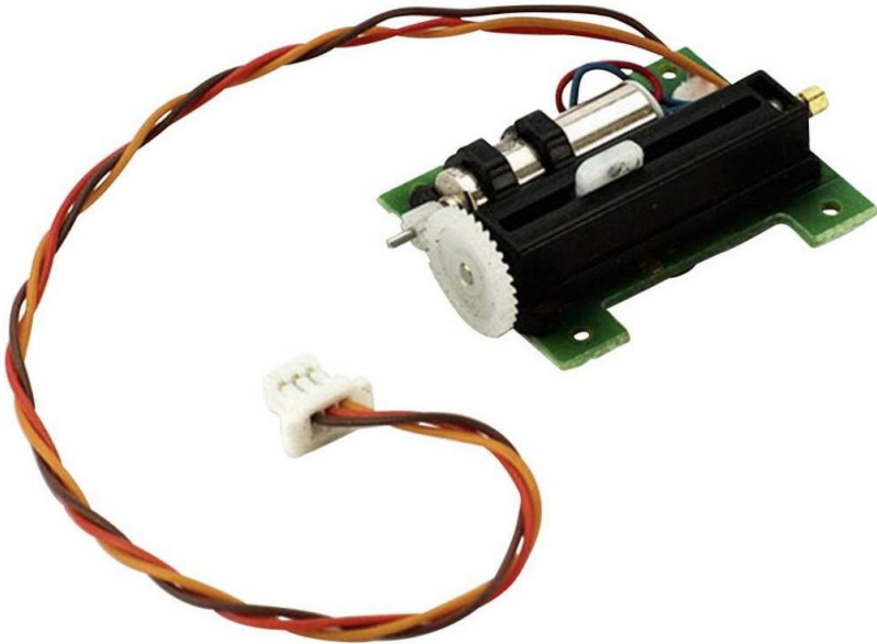
Figure 37: Spectrum Mini servo linear servo Gear box material. [26] .
